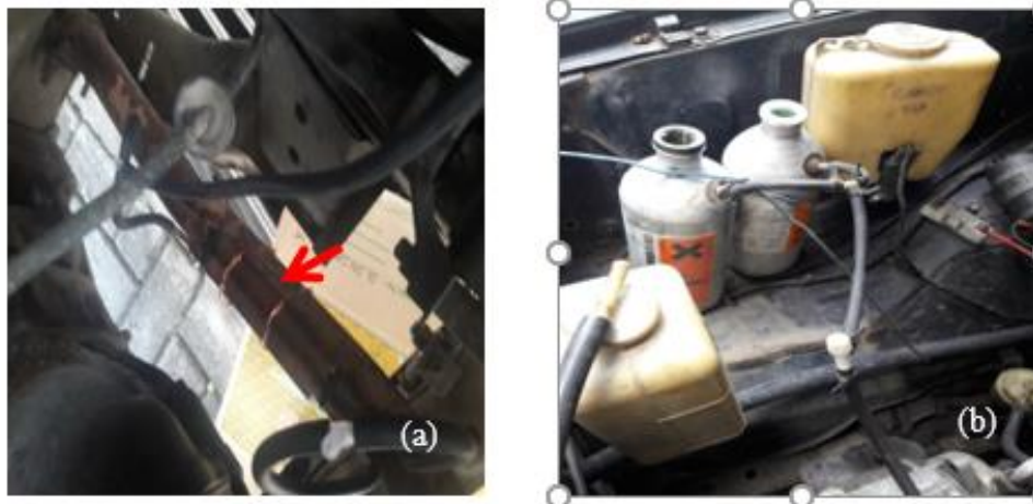
Gambar 2. a). Pemasangan pipa-pipa katalis HCS Ganda, b). Tabung pertamax
